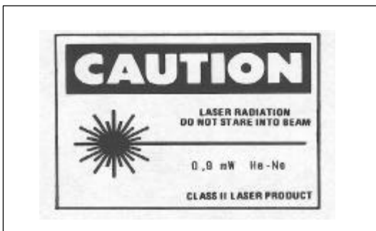
Figuur 1 Voorbeeld van waarschuwingsetiket op een laser.
