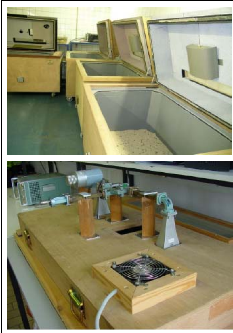
Figuur 1 Bovenste foto: overzicht van de blootstellingsopstellingen. In de binnenkant van het deksel van de voorste opstelling is een 970 MHz antenne te zien. Onderste foto: Buitenaanzicht van de 9,70 GHz- opstelling met de twee hoornantennes in het gesloten deksel. Bron: proefschrift Adang. 1
